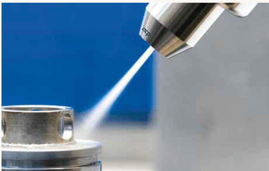
Bild 1: Mit der CO 2 -Schneestrahlnreinigung lassen sich definierte Bauteilbereiche gezielt, trockene und rückstandsfrei reinigen, beispielsweise vor oder nach Laserschweißprozessen
